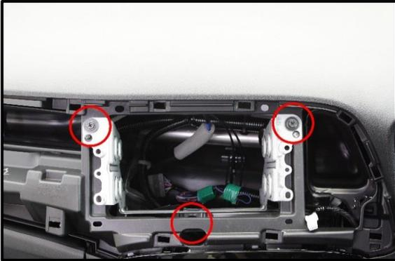
画像にあります赤い○印のネジ(3箇所)をプラスドライバーで外し、デッキ取付金具を車両から取り外します。
