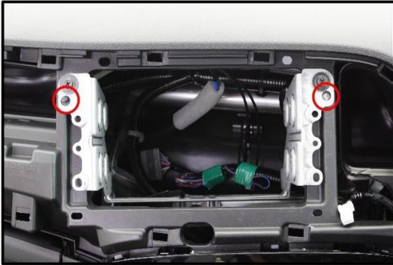
ナビ本体がフェイスパネルと干渉する場合はナビ本体を車両へ固定するネジ部分でナビ本体の位置を微調整します。
