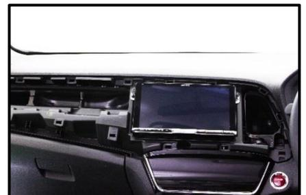
インストルメントパネルを車両に組み付けをし、本製品のフェイスパネルを仮合わせしてナビ本体がフェイスパネルに干渉しないかを確認します。
