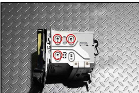
デッキ取付金具の赤い○印の3箇所にナビ製品に付属されております取付ネジで取り付けし、ナビ本体を車両に取り付けます。
