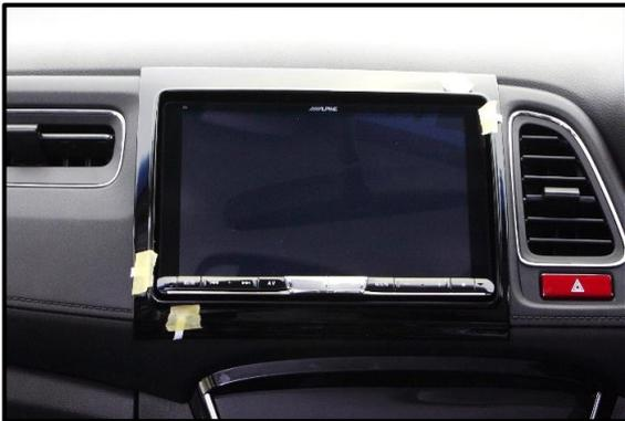
ナビ本体とフェイスパネルとの隙間が均一になれば、一度フェイスパネルを外し、両面テープの剥離紙を少し剥がしてインストルメントパネルに合わせます。
