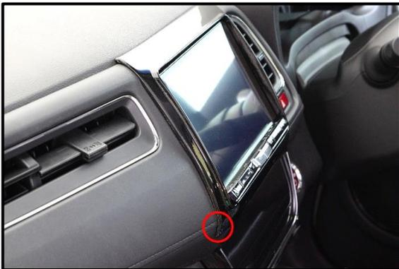
両面テープで接着する際、赤い○印部分のインストルメントパネルにある段差部分が合っているか確認しながらしっかりと接着します。
