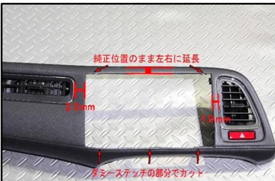
インストルメントパネルの左右にありますエアコン吹き出し口から助手席側が23mm、運転席側が10mm、上部は純正位置のまま左右に延長をし、下部はダミーステッチの部分にマスキングテープで切り取る位置の印をしてホットナイフでパネルを切り取ります。
